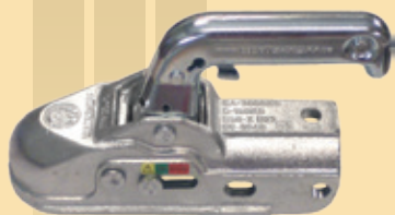
10.155 Kulhandske WW30 K+Z Winterhoff Universal Gjutjärn. Bultar Kors/Sida. Dragrör dia 45/50 mm Totalvikt upp till 3000 Kg. Passar med Robstop låset.
