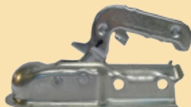
10.114 Kulhandske AK7 Alko Kober Bultar i sida. Dragrör dia 35 mm Totalvikt 750 kg.
