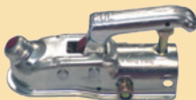
10.192 Kulhandske AK160 Alko Kober Universal Bultar i kors. Dragrör dia 45/50 mm Totalvikt upp till 1600 Kg. Passar med Alko Safety Låset.
